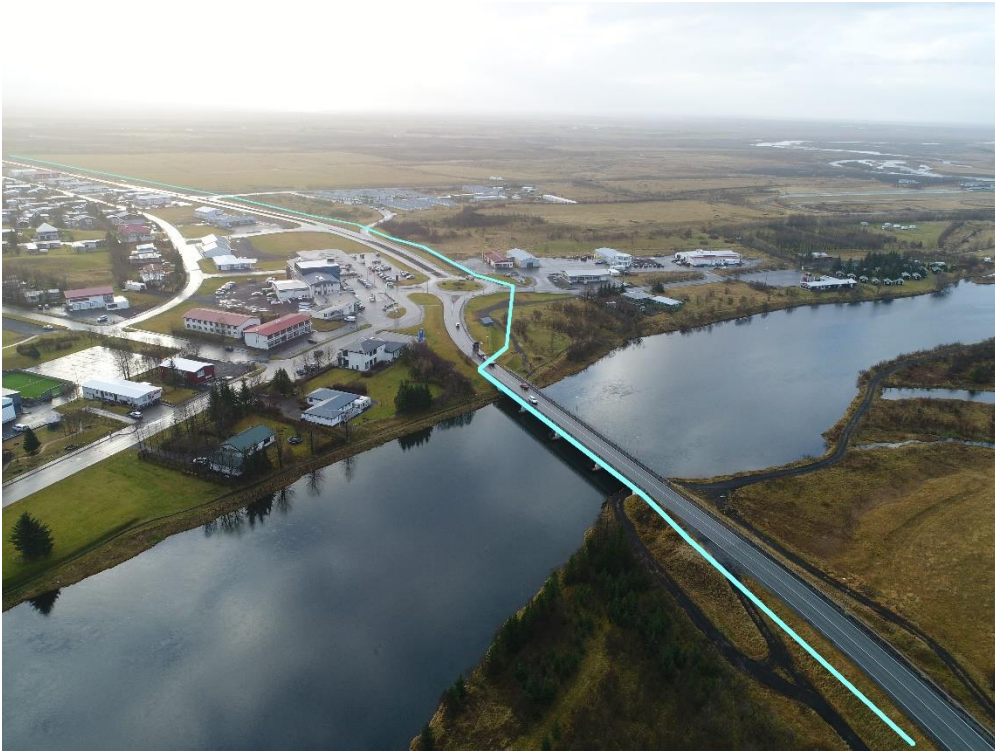
Mynd 3.7 Lega strengsins (blámerktur) meðfram Suðurlandsvegi í gegnum Hellu. Horft til suðurs.
